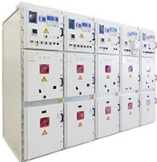
Комплектные устройства КРУ-РЭС предназначены для создания распределительных устройств напряжением 6 или 10 кВ. В них может быть установлена различная коммутационная аппаратура и устройства микропроцессорной защиты. Широкая гамма исполнений позволяет укомплектовать распределительное устройство любой сложности и назначения. КРУ-РЭС изготавливаются на номинальный ток до 3150А. ТУ341470-004-83838918-2014.
